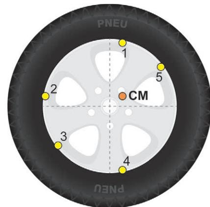
Em qual ponto deve ser fixada a peça de chumbo para corrigir a posição do centro de massa desse conjunto roda/pneu?
